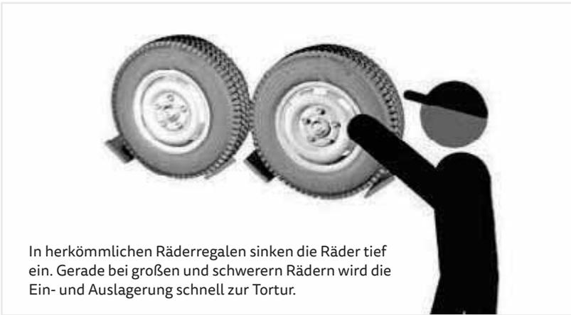
In herkömmlichen Räderregalen sinken die Räder tief ein. Gerade bei großen und schwerern Rädern wird die Ein- und Auslagerung schnell zur Tortur.
