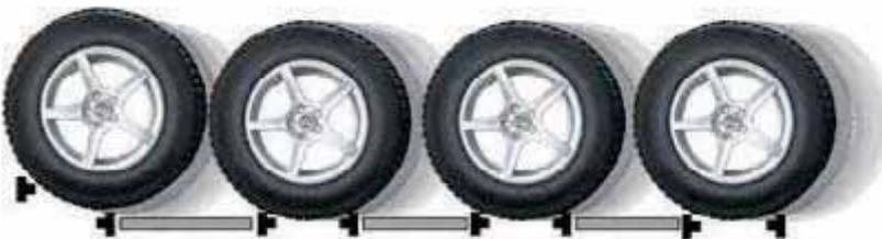
In die patentierten Abrollböden der SAL sinken die Räder dagegen nur wenige Millimeter tief ein. Dadurch geht das Ein- und Auslagern schnell und vor allem leicht von der Hand.
