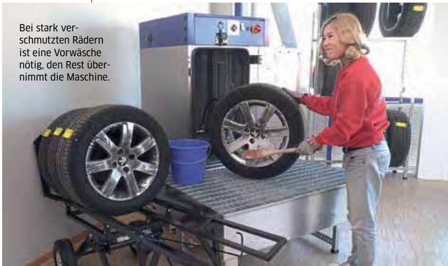
Bei stark verschmutzten Rädern ist eine Vorwäsche nötig, den Rest übernimmt die Maschine.
