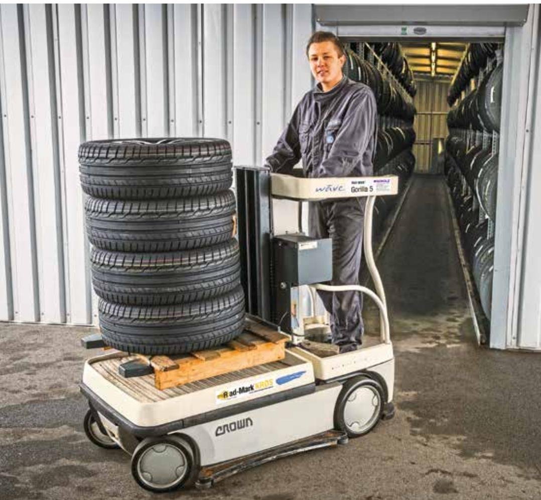
Im eingefahrenen Zustand kann man das Potenzial eines „Gorillas“ schon erahnen. Er kann einen kompletten Radsatz auf einer Palette aufnehmen und transportieren.
