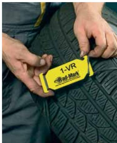
Schritt 2: Die passenden Schilder gemäß der Radposition (VR, VL, HR, HL) am Reifen anbringen. Dazu muss der Monteur einfach nur das Gummiband durch die Felge führen und am Schild einhängen.
