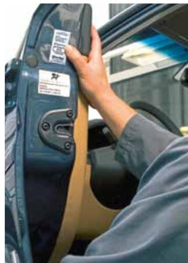
Schritt 3: Die Nummer und Lagerort des Radsatzes wird am Türholm des Kundenfahrzeugs mit der passenden Garderobenmarke hinterlegt. Beim nächsten Reifenwechsel weiß der Monteur auf einen Blick, wo der passende Satz liegt – ohne EDV oder Listen.
